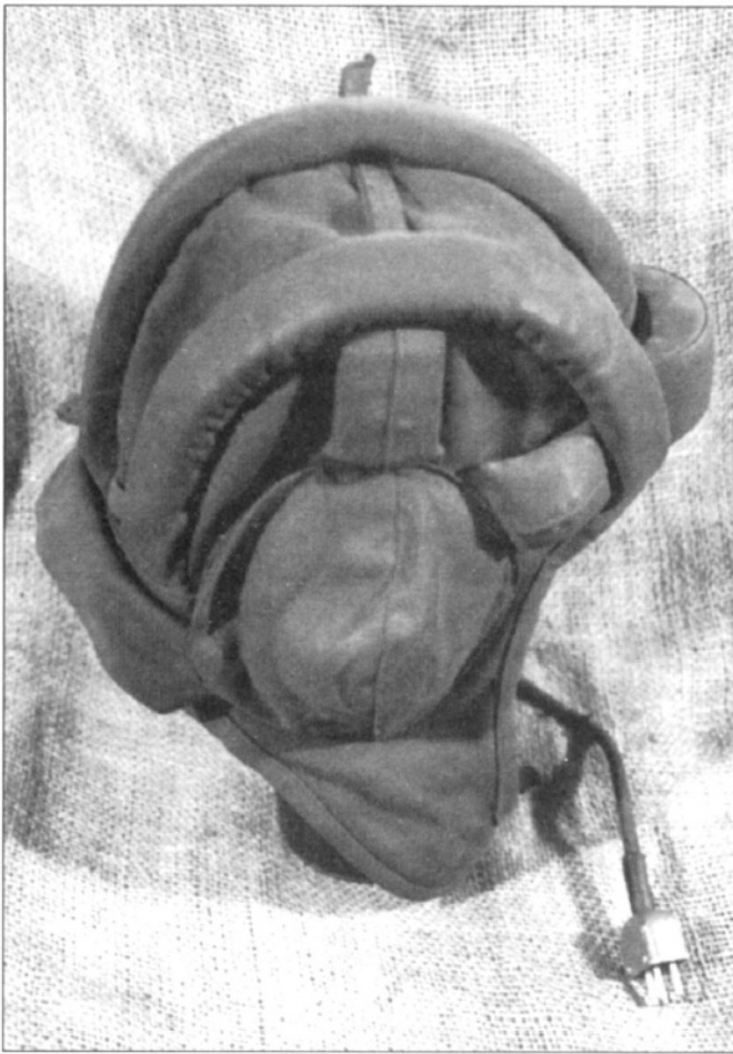
Стандартный летний шлемофон танкиста, от шлемофона времен Великой Отечественной войны он отличается только формой наушников. Хорошо виден кабель и разъем для подключения к танковому переговорному устройству.
