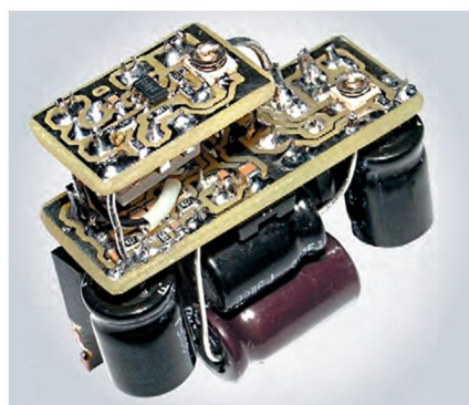
Рис. 24. Фотография стабилизатора -12,5 В с платой защиты
