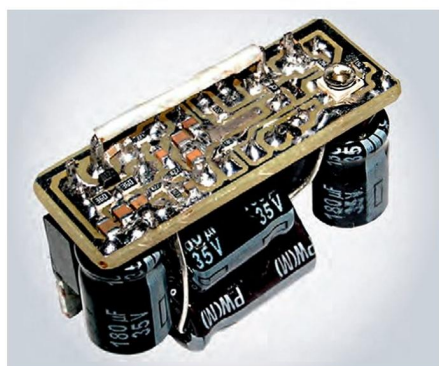
Рис. 23. Фотография стабилизатора +12,5 В без платы защиты
