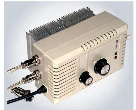
Рис. 33. Усилитель на ОУ LM3886 в сборе
