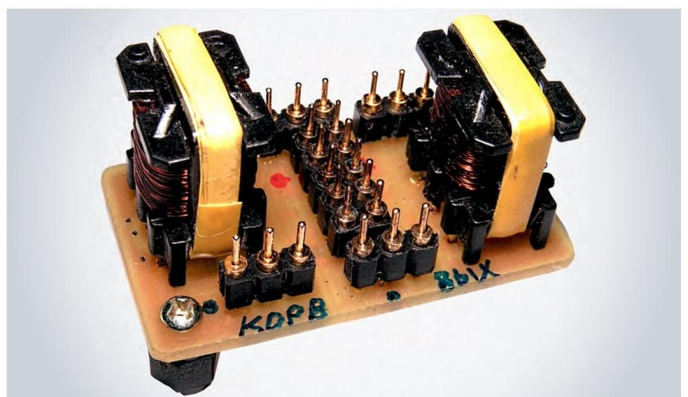
Рис. 29. Фотография платы регулятора громкости на Ш-образных сердечниках Е 13/7/4
