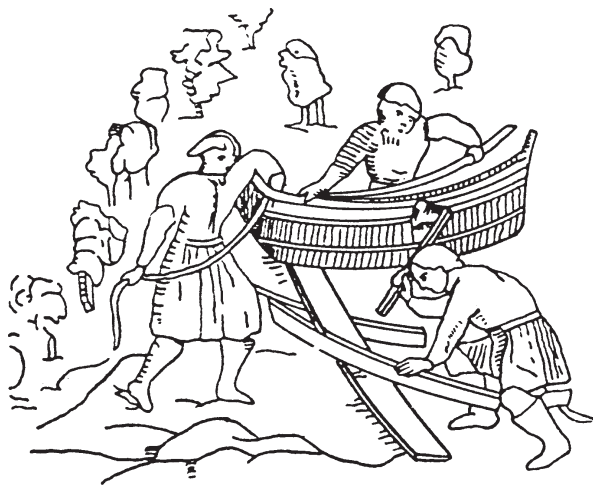
Постройка судна (крепление бортов)
