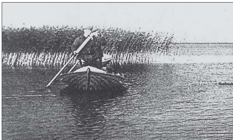
Та же лодка на ходу. Обращает на себя внимание то, что верхняя доска, накрывая, срезает нижние, спрямляя линию борта
