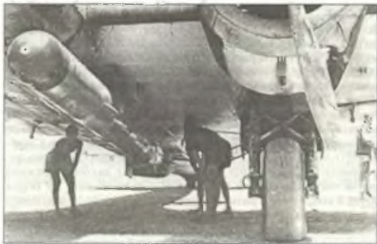
Торпеда под центропланом SM.79, самолет имел узлы подвески для двух торпед, но обычно подвешивалась только одна
