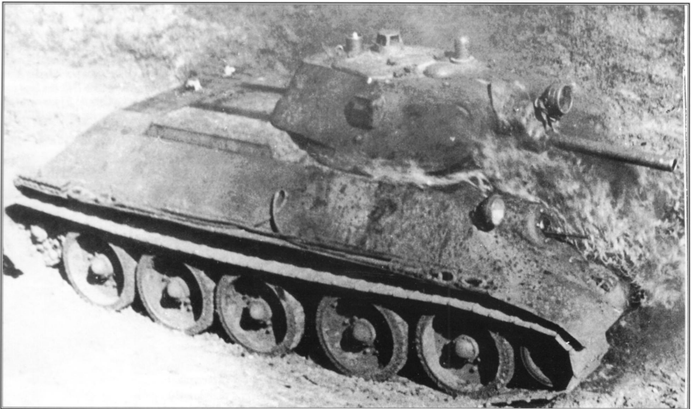
Prototyp czołgu A-34 nr 2 w czasie prób hermetyczności stanowiska kierowcy i przedziału silnikowego dla płonącej benzyny, wiosna 1940 roku. An A-34 No. 2 tank prototype seen during the trials of driver's station and engine compartment hermetic of burning petrol, Spring 1940. [RGAE]
