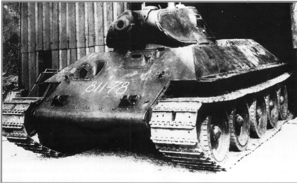
Piąty seryjny T-34 nr 811-78. Kadłub posiada belkę łączącą przednie opancerzenie, czołg z „szeroką” wieżą, właz kierowcy bez odbojnic. Armata Ł-11 nie zamontowana.
