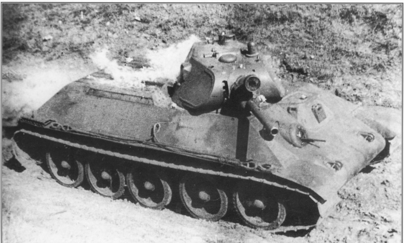
Prototyp czołgu A-34 nr 2 w czasie prób hermetyczności stanowiska kierowcy i przedziału silnikowego dla płonącej benzyny, wiosna 1940 roku. An A-34 No. 2 tank prototype seen during the trials of driver's station and engine compartment hermetic of burning petrol, Spring 1940. [RGAE]
