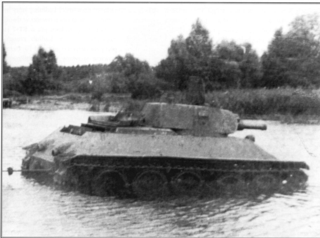
Prototyp czołgu A-32 zagrzebany podczas pokonywania rzeki, 1939 rok. Z tyłu założony hol. An A-32 tank prototype seen bogged in the river, 1939. Note towing rope mounted on the rear. [ASKM]
